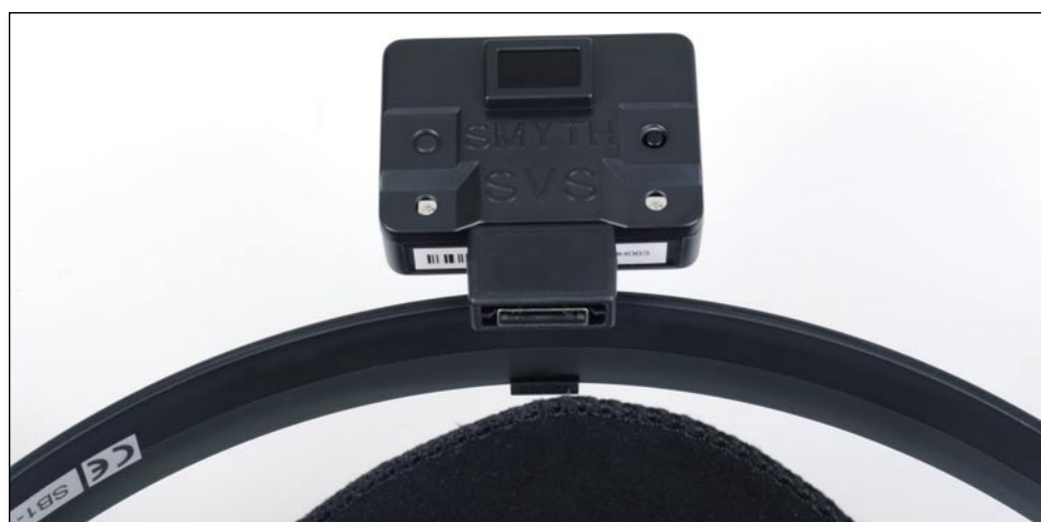
Durch einen Klipp wird die Headtracker-Einheit auf dem Kopfbügel des Kopfhörers befestigt
